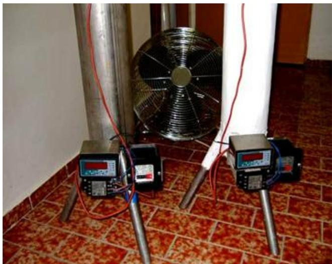
Na zhotovení tohoto zařízení (viz.foto) byly použity: trubky z nerezové oceli o průměru 120 mm a délce 1000 mm, topné články o výkonu 1 kW a digitální termostaty s teplotním rozmezím od -50°C do +150°C s přesností +/- 0,1°C.
