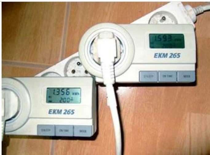
Termostaty byly nastaveny tak, aby udržovaly teplotu vody v trubkách v rozmezí 90°C-91°C. To znamená, že při klesání teploty vody pod 90°C termostat ohřev zapínal a při teplotě vody nad 91°C termostat ohřev vody vypínal. Po dvou hodinách testu jsme dosáhli těchto výsledků:
